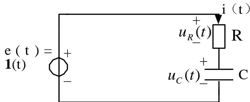
图5.23 激励为单位阶跃信号的RC串联一阶电路
